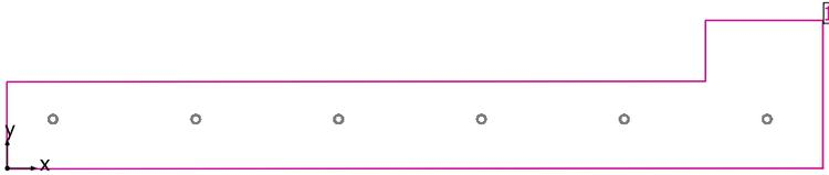
Altura interior del local: 2.800 m, Grado de reflexión: Techo 70.0%, Paredes 50.0%, Suelo 20.0%, Factor de degradación: 0.85
