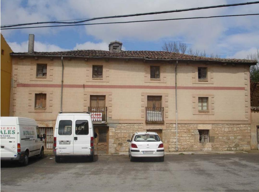
Edificio de viviendas. Planta baja de mampostería. Planta superior con revoco y fingido de sillares, enmarcado de huecos e impostas. Alero de canes de madera.
