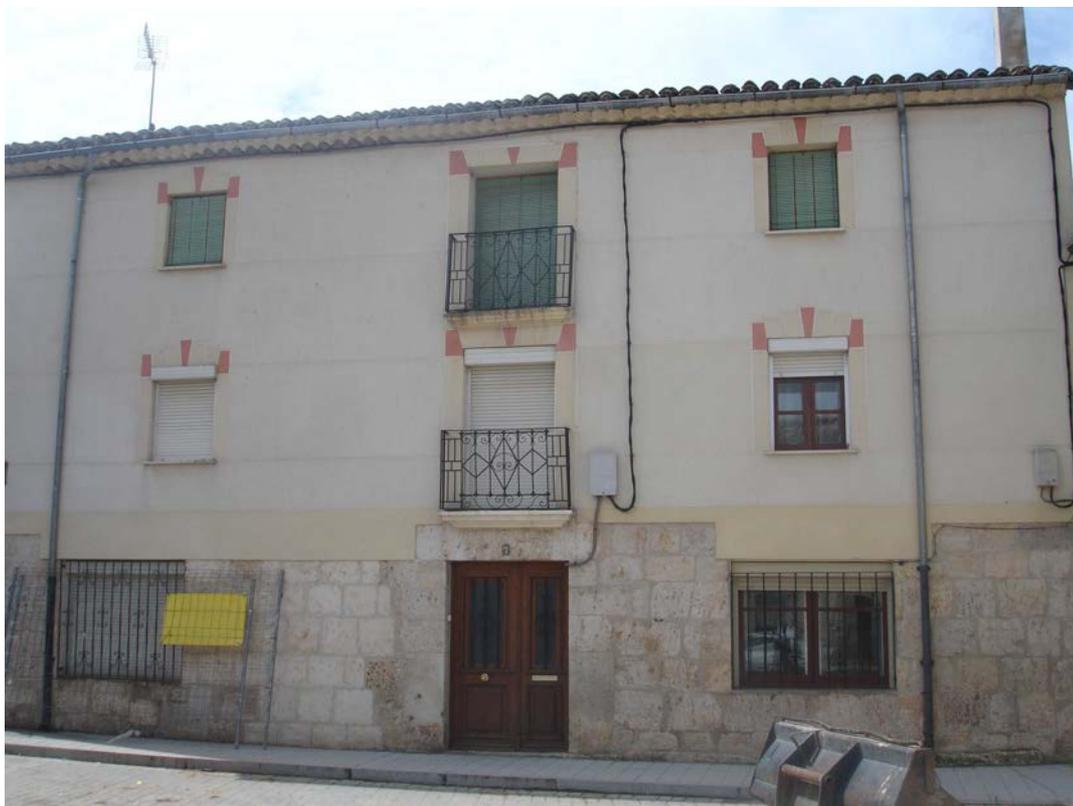
Edificio de viviendas. Tres plantas. Planta baja de mampostería. Plantas superiores de ladrillo macizo revestido con fingido de sillares. Enmarcado de huecos. Alero de ladrillo macizo. Cubierta a dos aguas
