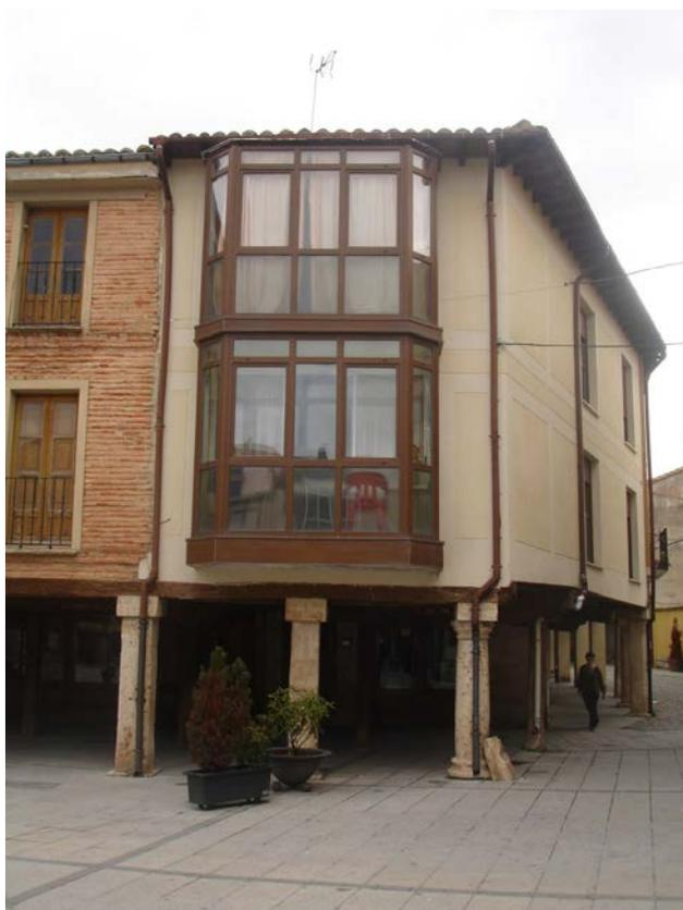
Edificio de viviendas levantado sobre el trazado de la antigua muralla, en esquina con el eje más primitivo de la ciudad. En él se produce el paso de la geometría del soportal doble que caracteriza la plaza al soportal sencillo que discurre por la calle Vega. De construcción semejante a sus contiguos, sus dos plantas superiores han sido demolidas y sustituidas, en una intervención torpe y muy agresiva para el conjunto urbano.
