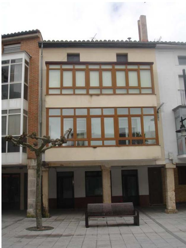
Edificio de viviendas. Cuatro plantas. Planta baja porticada característica del núcleo, con pies derechos de piedra de sección cuadrada. Galerías metálicas en plantas primera y segunda.
